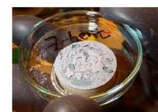
Obr. 4 Kompaktovaný bentonit s vrstvou směsi Fe prachu a korozních produktů; lab teplota, 189 dnů.
