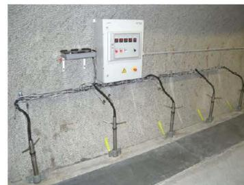
Obr. 2 Umístění vzorků v pěti vrtech v Grimsel Test Site.
