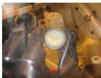
Obr. 1 Bentonit (kontakt s kovovým vzorkem; vlevo) a kovový vzorek se zbytky bentonitu v anaerobním boxu (Dobrev et al. (2017)).
