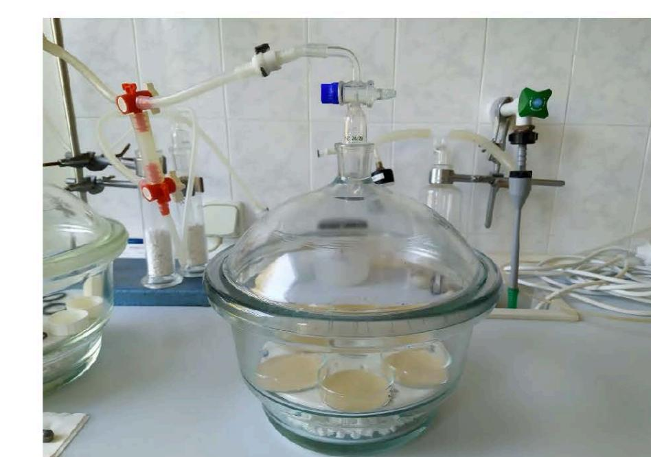
Obr. 6: Stanovení měrného povrchu metodou za použití EGME
