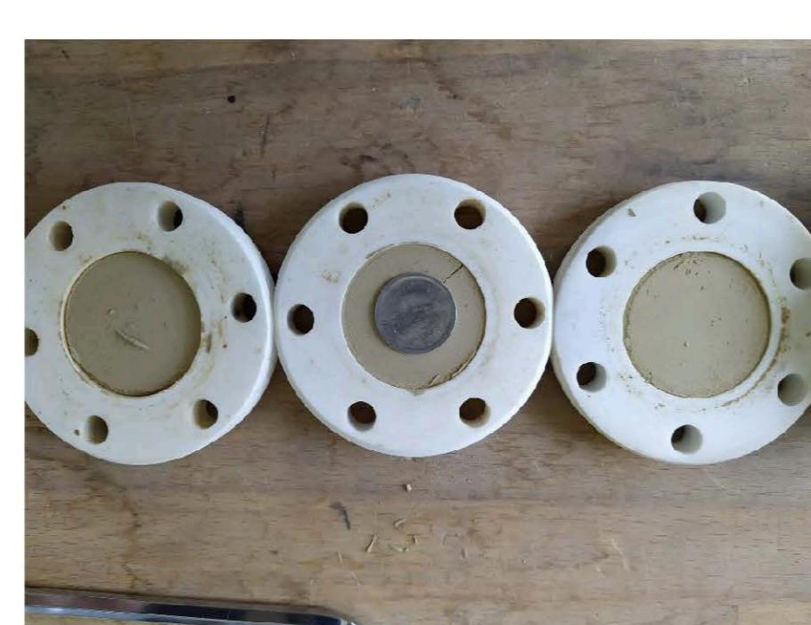
Obr. 3: Cela s bentonitem BCV „HITEC INPUT“ se zapuštěným čidlem teploty a relativní vlhkosti
