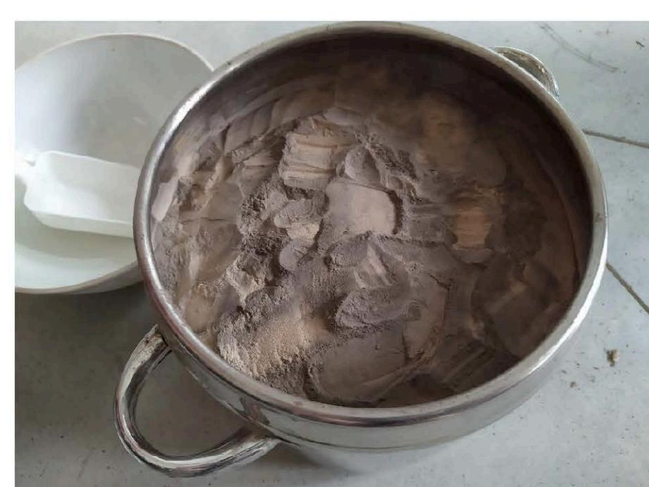
Obr. 1: Bentonit BCV „DRY“ 0,5Y
