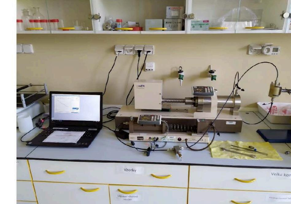
Obr. 5: Měření nasycené hydraulické vodivosti
