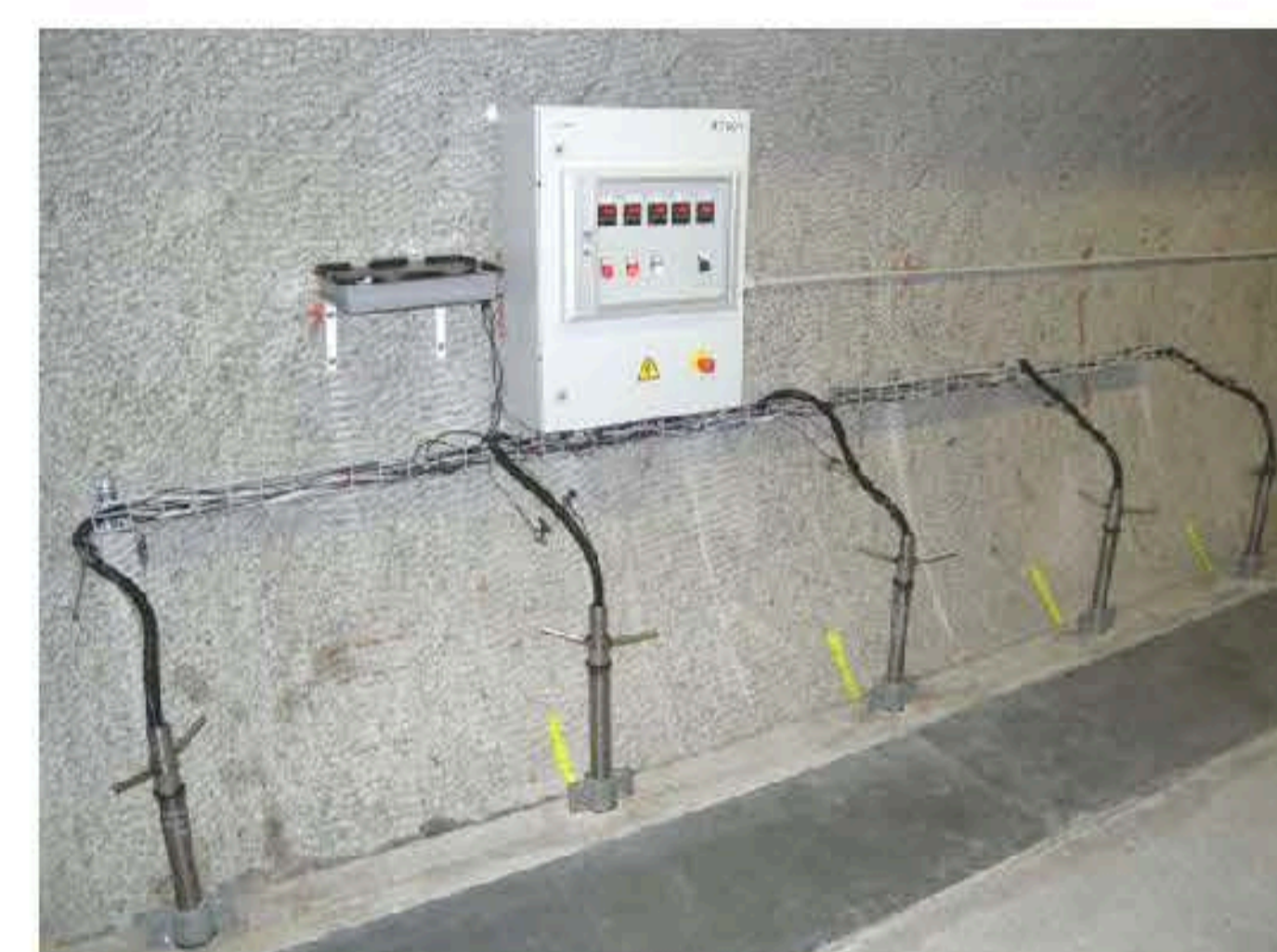
Obr. 2 Umístění vzorků v pěti vrtech v podzemní laboratoři Grimsel Test Site
