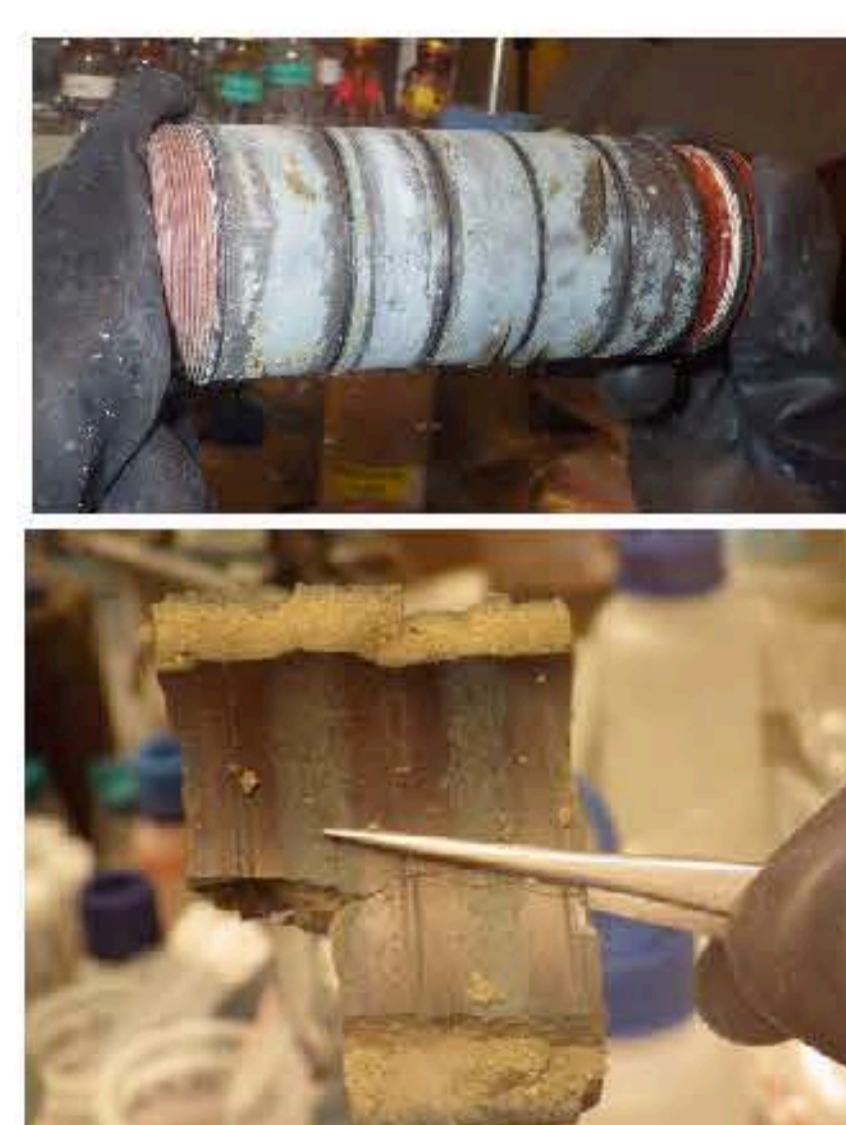
Obr. 3 Vzorky uhlíkové oceli po roční expozici v českém bentonitu (nahore). Vzorek bentonitu s korozními produkty (dole)
