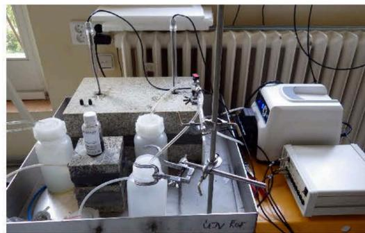
Instrumentovaný testovací blok pro in-situ záznam změn frekvence magnetické susceptibility
