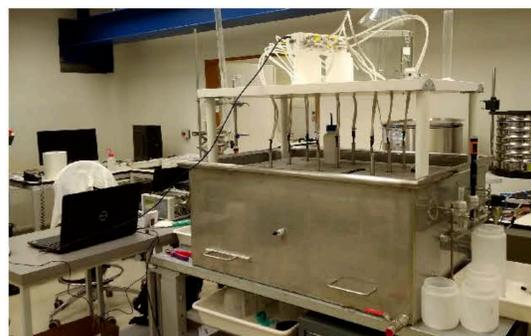
Instrumentovaný blok pro in-situ záznam změn vodivosti v čase (KCl, NaCl)
