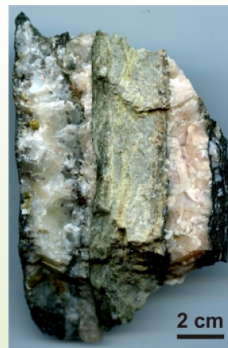
žíla s více generacemi kalcitu a alterovanou horninou z rudního stádia, R-7S, 21. patro, 1. zóna
